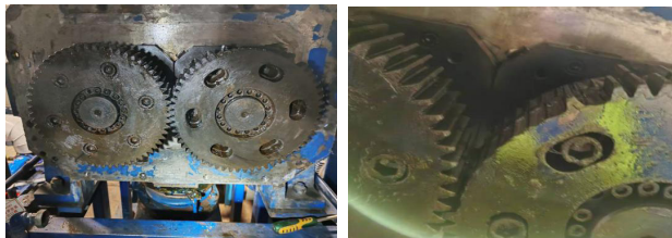
图1 气冷罗茨泵从动齿轮损坏图片
