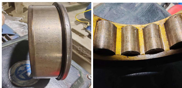
图3 罗茨泵轴承腐蚀磨损严重
