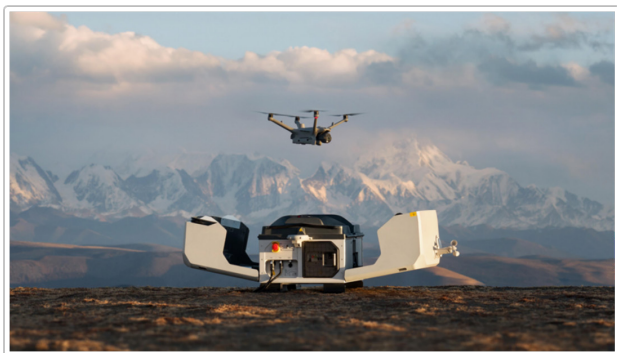
图1所示为大疆机场3基地与Matrice 4D无人机的搭载场景。
