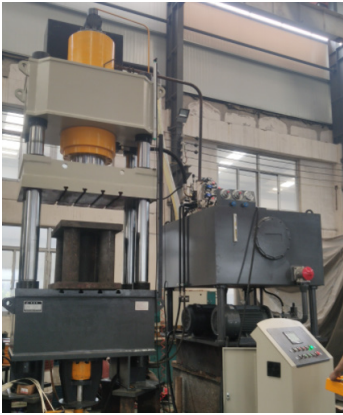
图2: 汽车热挤压锻造液压机
