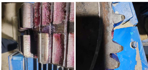
图2 齿面磨损、齿跟裂纹情况
